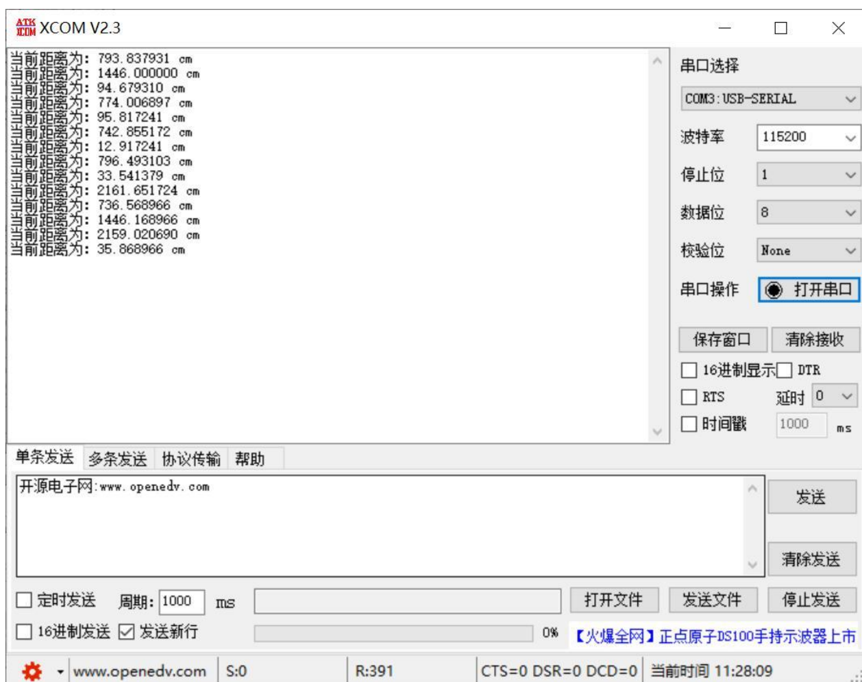
图 4.17 HC-SR04 超声波模块测量到的距离
